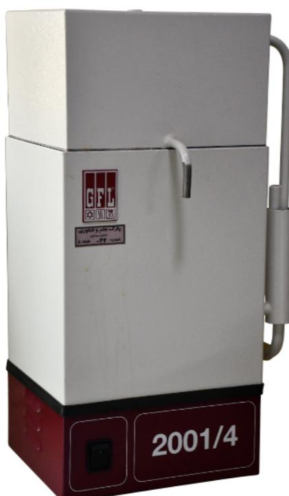
نام دستگاه: آب مقطرگیری یکبار تقطیر، مدل: ۲۰۰۱/۴
